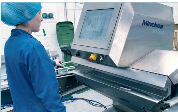
Il sistema di ispezione a raggi X Dylight rileva in modo affidabile i corpi estranei nelle fasi di produzione
