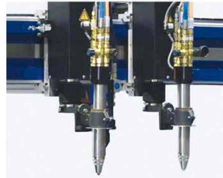
Die Maschine kann bis zu 4 ALFA-Brenner tragen, die mit schnellem Düsenwechsel ohne Werkzeug eine hohe Produktivität erlauben.
