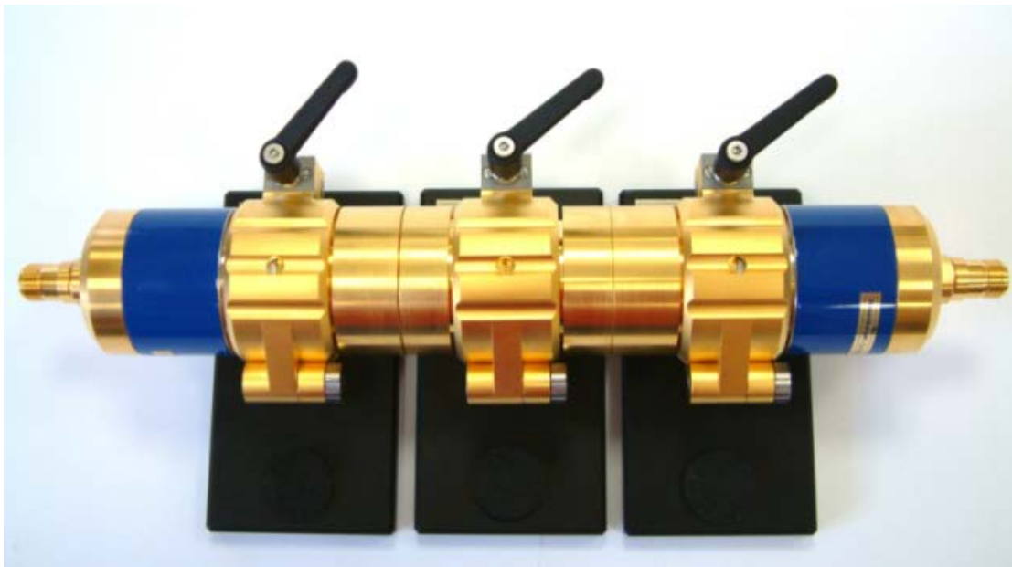
Bild 14: CoMeT-K - Messen von EMV-Dichtungen und Durchführungen Figure 14: CoMeT K - Measuring of EMC gaskets and feedthroughs
